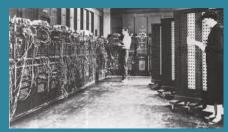
ENIAC: il primo computer elettronico della storia, utilizzato per il tracciamento delle rotte dei razzi balistici dalla Marina USA. Superficie: 180 mq, peso: 30 tonnellate, 18.000 valvole termoioniche installate, 1500 relais, dissipazione termica pari a 200 Kw/h!
