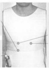
III Due piccole aree metallici funzionano da elettrodi e riievano i battiti cardiaci. In futuro, con un ulteriore metallico. rileveranno anche la ischemie
